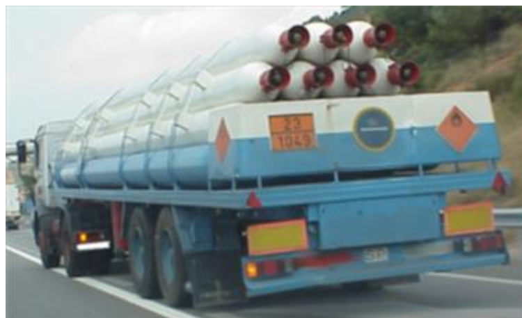
VEHICULO BATERIA FORMADO POR TUBOS
